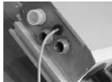
Der Fühler wird dann wieder zusammen mit dem Stöpsel eingesetzt.
