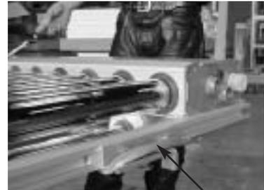
Ein Seil oder Tragegurt wird von der Kollektorrückseite her durch die Kerben über die Kollektorhaken und wieder hinter den Kollektor gezogen.
