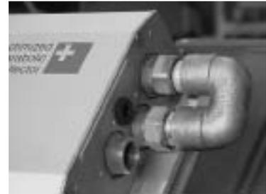
Der Blinddeckel wird ebenfalls aufgeschraubt. (Anzugmoment 30 - 40 Nm)
